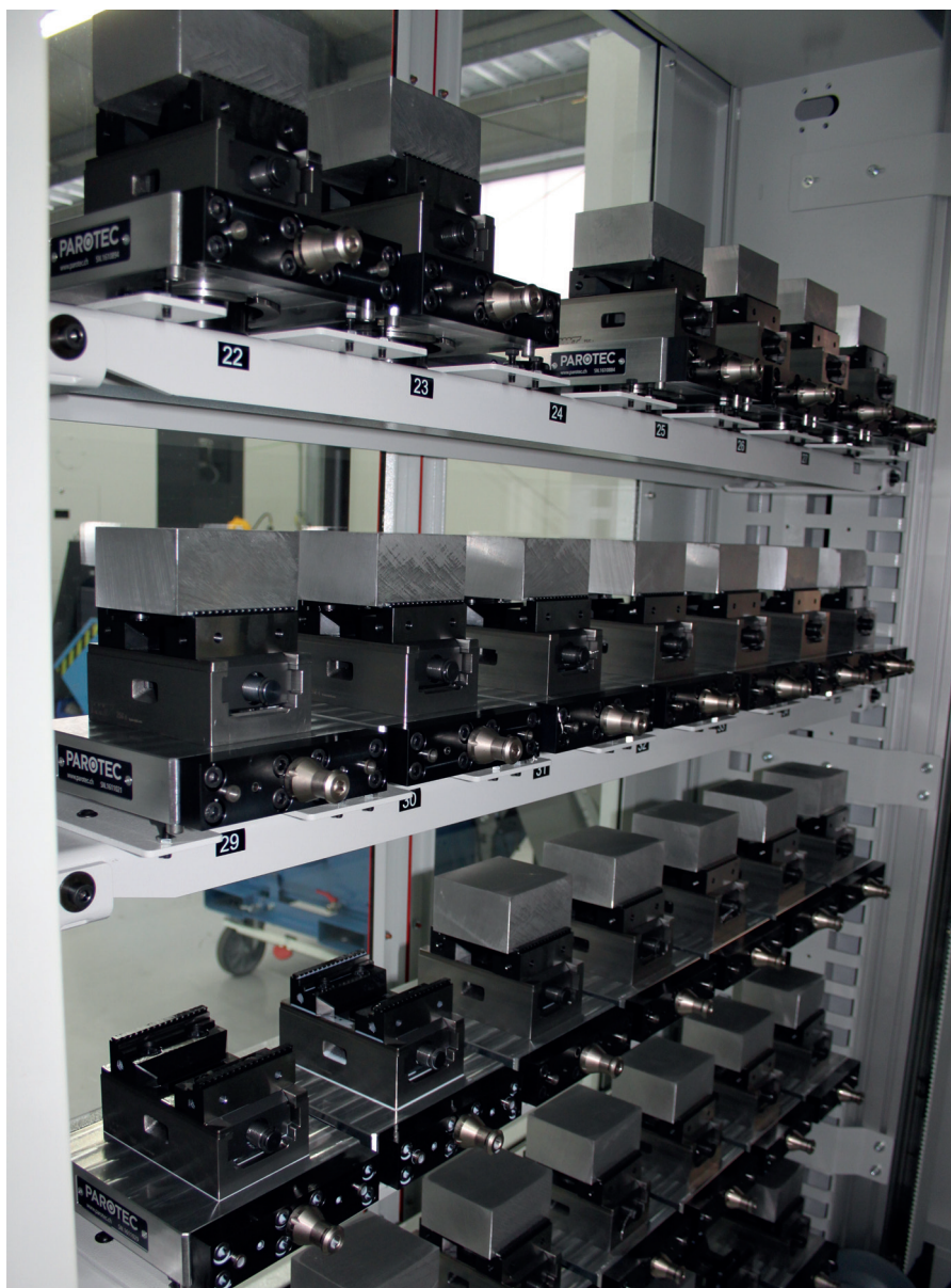
Bild 1: Werkstückmagazin mit integriertem Paletten-Handlingsystem zur Beschickung des 5-Achsen-BAZ, bestückt mit insgesamt 56 Stück standardisierten Zentrischspannern von Gressel vom Typ C2 80 L-130
